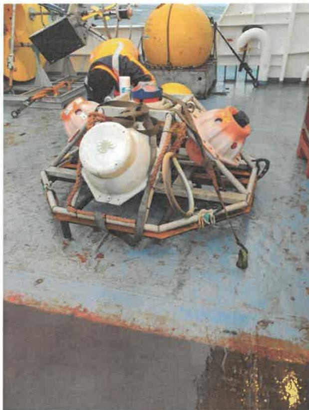
Photo de la cage instrumentée avec le courantomètre au centre
