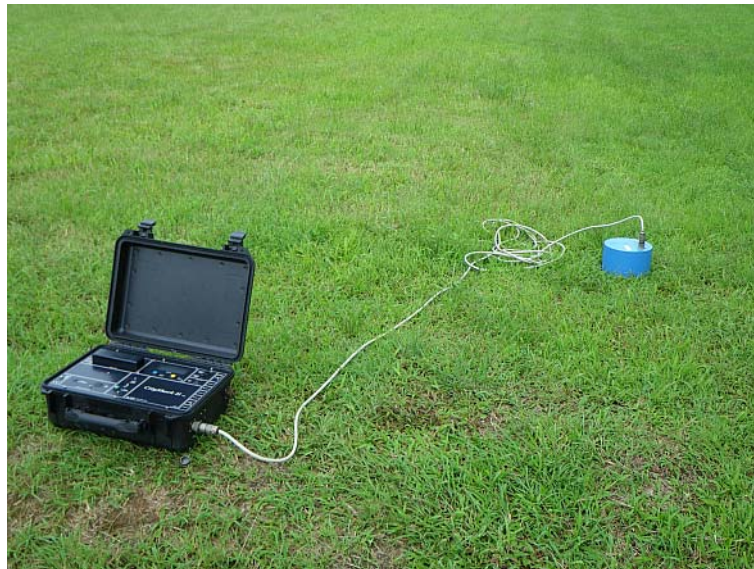
Figure 1 : Dispositif H/V utilisé dans les Pyrénées-Orientales : à gauche : la station d'acquisition CityShark et à droite : le sismomètre tridimensionnel Lennartz 5 secondes.
