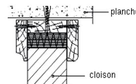
Liaison cloison- plancher (extrait des règles PS-MI)
